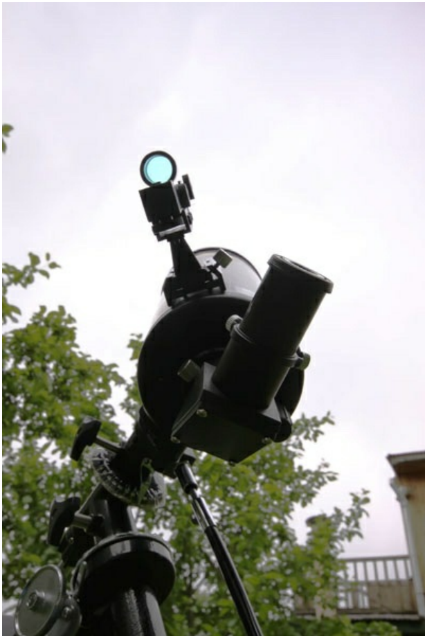
Искатель у обоих телескопов типа "red dot" (с красной точкой) и имеет многослойное просветление:
