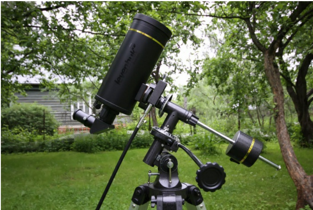
У МАК 105 лучше выполнен узел крепление телескопа к монтировке: в виде П-образной конструкции на пробковой подложке:
