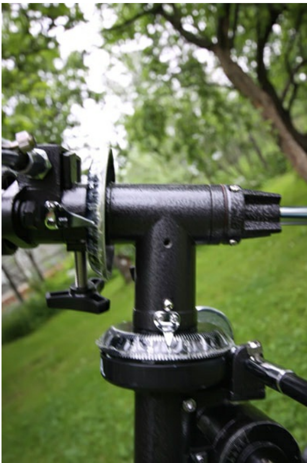
Узел настройки полярной оси выполнен надёжно на обеих монтировках. Ручки для установки по широте места наблюдения для удобства имеют реверс:
