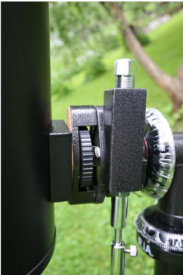
Винты фиксации осей у МАК 105 больше, выполнены в пластике и удобнее в работе, чем аналогичные винты у МАК 80:
