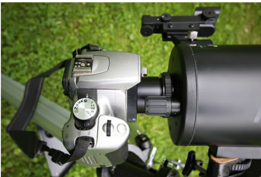
Крепление специальной астрокамеры:
