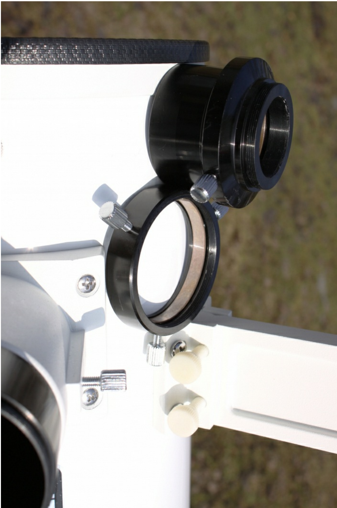
Двухдвойное фокусирующее устройство телескопа комплектуется Т-адаптером, позволяющим использовать телескоп в качестве астрографа.
