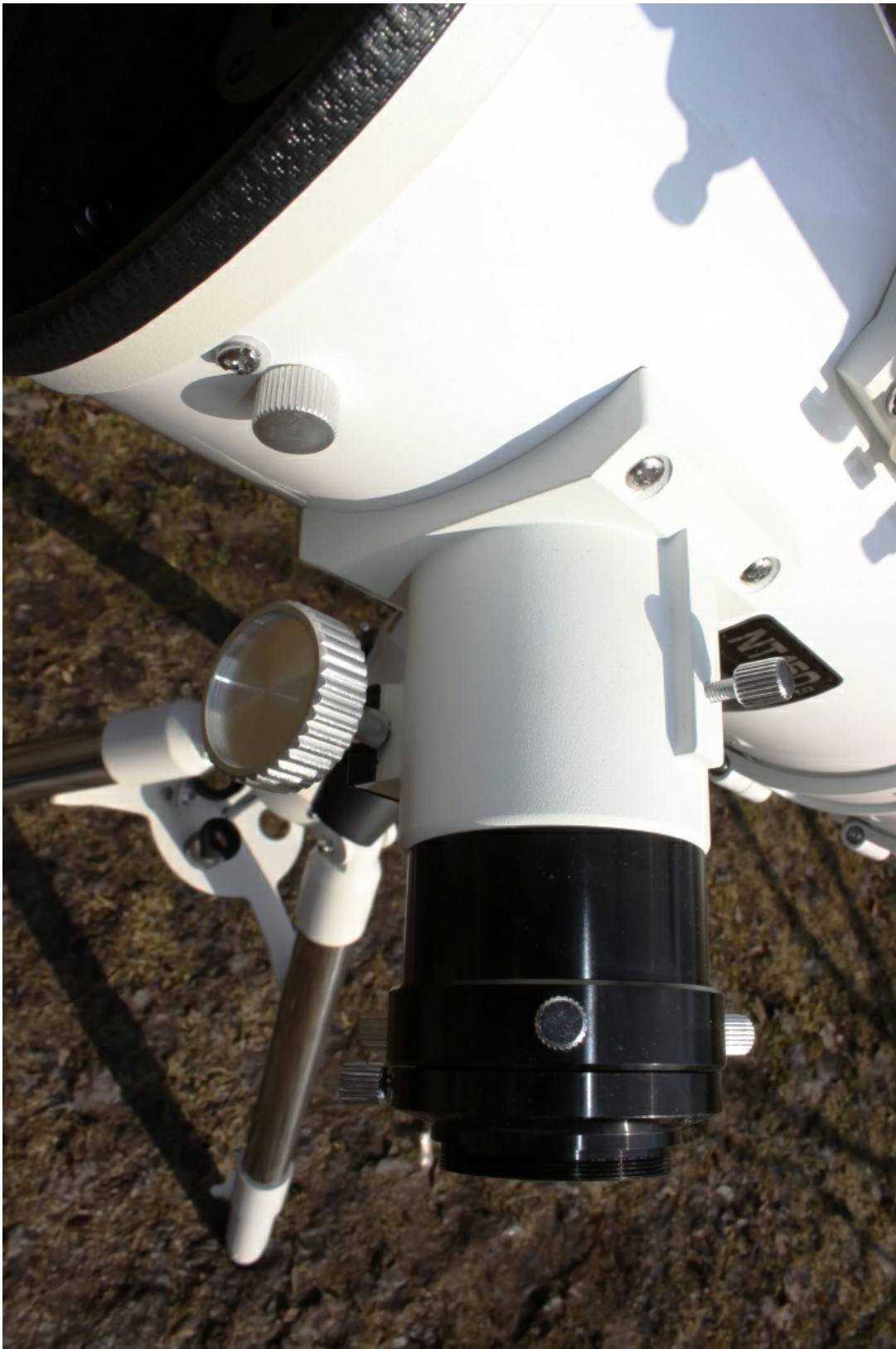
Люфт выбирается винтом в основании фокусера. Фокусер полностью разборный, что сильно упрощает замену смазки. Ручки большие и удобные.
